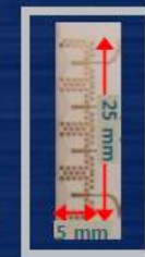
Array Antenna 4x1 (=4) Antenna Elements
